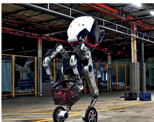
Robot Handle kombinuje kola a nohy, aby zajistil agilní manipulaci s vysokou silou
