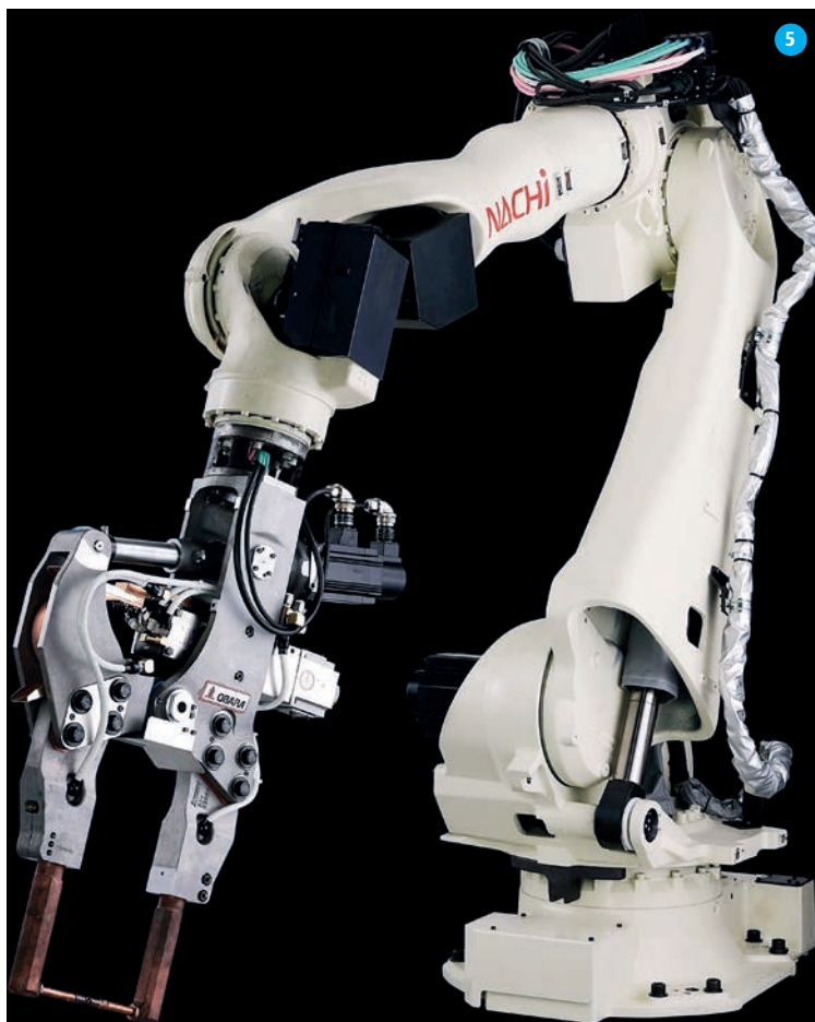
5 SRA robot s průchozím zápěstím pro kabeláž - typický představitel bodového svařovacího procesu v automotive.
