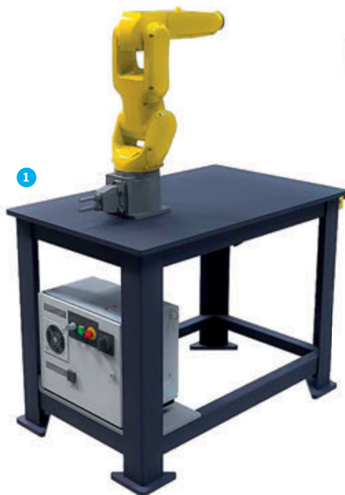
1 Příklad předkonfigurovaného pracoviště s robotem Fanuc LR Mate 200iD.
