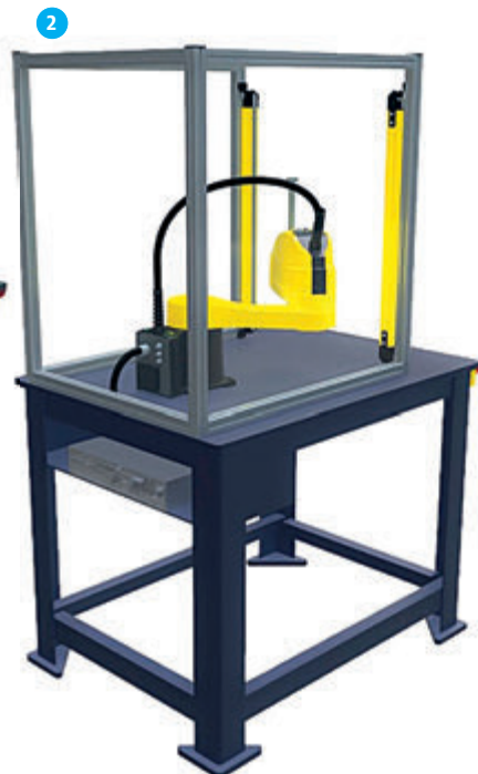
3 Pro mobilní předkonfigurované pracoviště jsou využity lehké roboty Hanwha.
